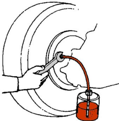
Dann die Entlüfterschraube mit einem Anzugsmoment von 11 Nm wieder anschrauben. Dieser Vorgang wird mit allen Radbremszylindern wiederholt bis diese Blasenfrei sind.
